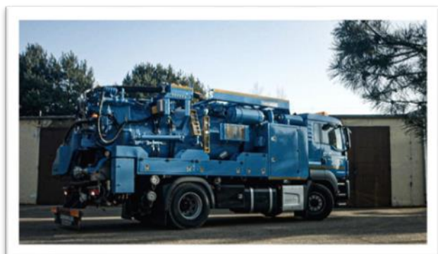
Samochód ciśnieniowo-ssący do obsługi i konserwacji sieci kanalizacji sanitarnej
